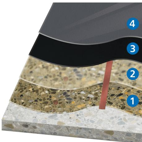
4. Strukturbeschichtung **KLB-SYSTEM EPOXID EP 233 EL+**
