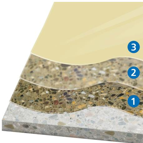
3. Revêtement avec **KLB-SYSTEM POLYURETHAN PU 420** - en option : injecter du granulé structuré **Strukturgranulat RQX 9/RQX 10**
