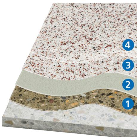
4. Scellement de tête **KLB-SYSTEM POLYURETHAN PU 484**
