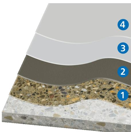
4. Scellement avec **KLB-SYSTEM EPOXID EP 740 E**
