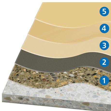
5. Scellement mat avec **KLB-SYSTEM EPOXID EP 740 E**
