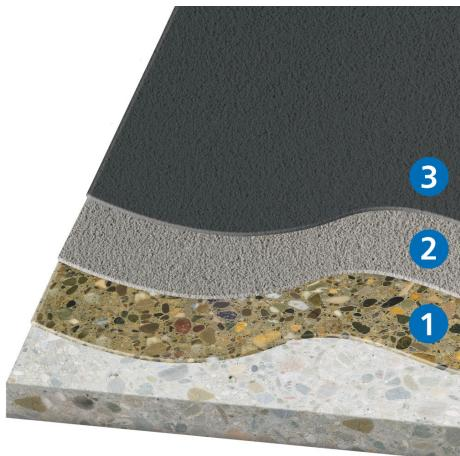
3. Scellement de tête avec **KLB-SYSTEM EPOXID EP 5570**
