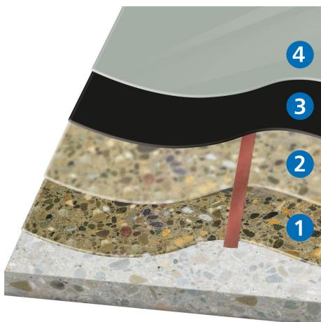
4. Beschichtung mit **KLB-SYSTEM EPOXID EP 200 EL+**
